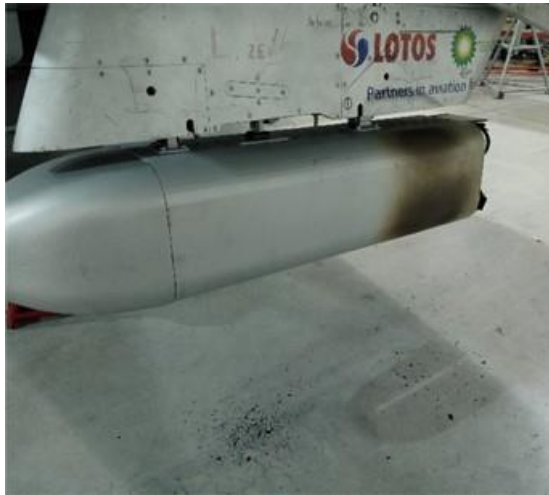
Rysunek 6.42 Stan HWP po teście „błędne zamontowanie 1 kg pirotechniki w uchwycie zasobnika” widoczne tylko ślady przegrzania tylnej części obudowy zasobnika, bez negatywnych skutków na uniwersalną belkę podwieszń i skrzydło samolotu TS-11 Iskra; cała energia spalania została zatrzymana wewnątrz zasobnika. Źródło danych: zdjęcia własne
