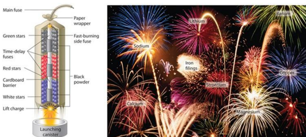
Rysunek 4.14 Chemia fajerwerków "multibreak": a) komory zawierają mieszaniny paliw i utleniaczy oraz związków do efektów specjalnych ("gwiazdy") połączonych zapalnikami zwłocznymi tak, że komory eksplodują etapami; b) finał pokazu - wiele ładunków pirotechnicznych jest wystrzeliwanych jednocześnie, aby uzyskać olśniewający wielokolorowy pokaz (etykiety wskazują substancje, które są odpowiedzialne za kolory fajerwerków). Źródło danych: [244]
