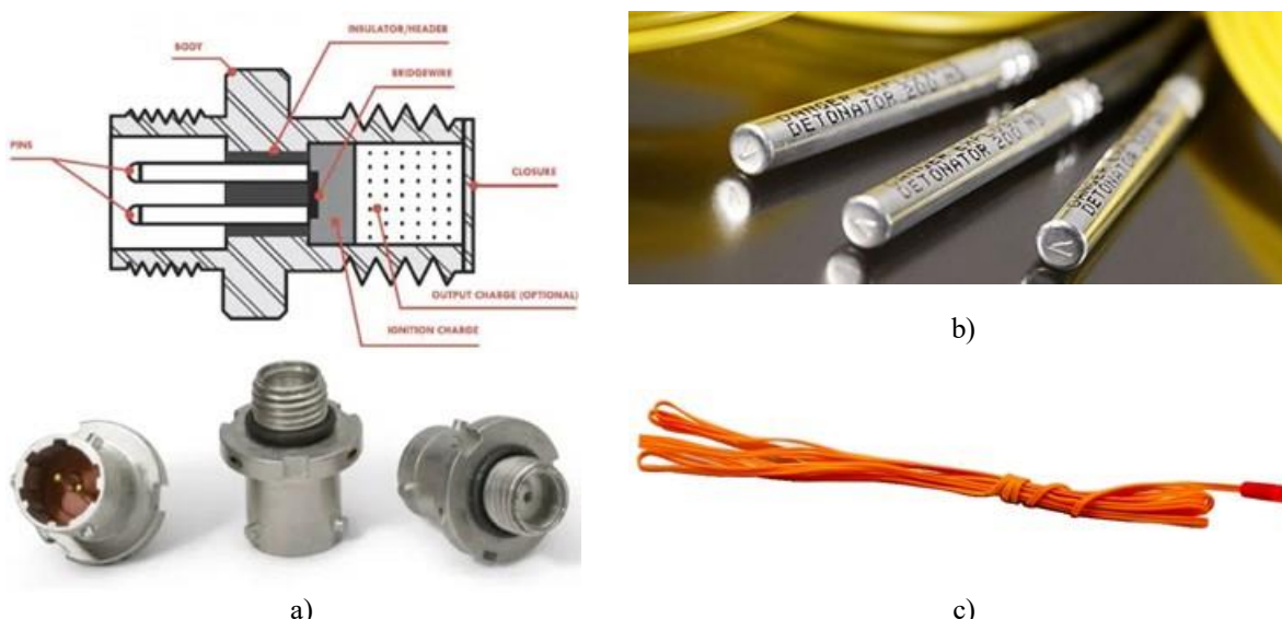
Rysunek 4.27 Zapalniki i zapłonniki elektryczne: a) budowa typowego zapalnika elektrycznego stosowanego w przemyśle, lotnictwie i kosmonautyce spełniającego wymogi normy MIL-DTL-23659F b) zapalnik elektryczny na bazie minii ołowiowej F/AD stosowany m.in. w górnictwie; c) zapalnik elektryczny klasy P1 z 3 metrowym przewodem używany do odpalania fajerwerków. Źródło danych: [381][383][535]
