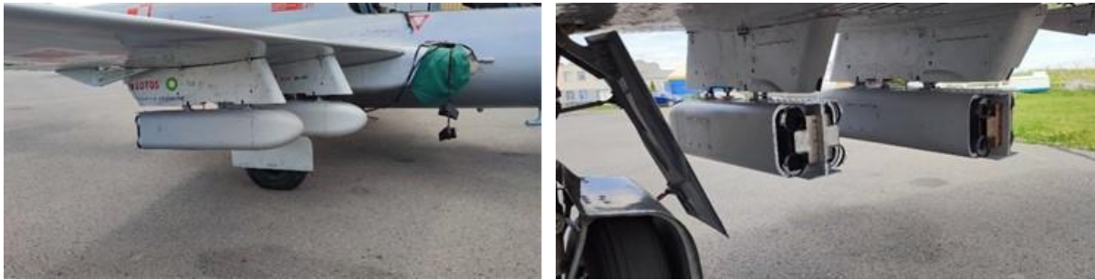
Rysunek 6.29 Konfiguracja podwieszenia po dwa zasobniki pod skrzydłem z każdej strony samolotu TS-11 „Iskra FBCS” używająca 8 kanałów sterowania pirotechniką Źródło danych: zdjęcia własne
