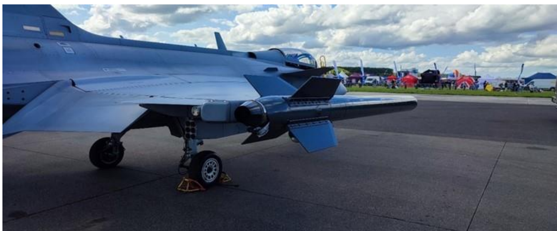
Rysunek 2.38 Wytwornica dymu na końcówce skrzydła samolotu SAAB JAS 39 Gripen. Źródło danych: zdjęcie własne
