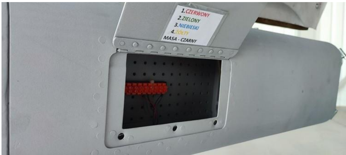
Rysunek 6.36 Modernizacja lewej pokrywy HZP w 2020 roku – dodano luk technologiczny. Źródło danych: zdjęcie własne
