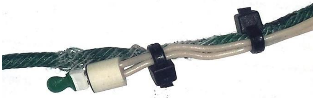
Rysunek 2.42 Zamontowany zapłonnik elektryczny na lonce wyrobu pirotechnicznego, przed osłonięciem taśmą. Źródło danych [534]
