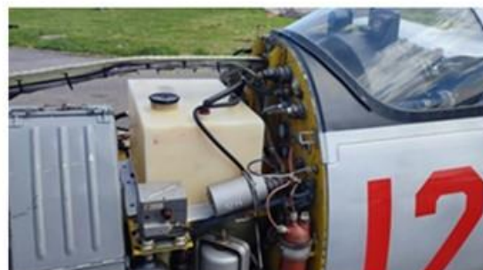
Rysunek 2.35 Instalacja wytwornicy dymu na samolotach TS-11 Iskra: a) schemat instalacji: 1. zbiornik cieczi (parafina, olej napędowy); 2. odpowietrzenie zbiornika; 3. korek gardzieli zalewowej; 4. przewód ssący; 5. pompa podpompowująca; 6. filtr siatkowy; 7. zawór jednokierunkowy; 8. złączka szczelna; 9. elastyczne przewody hydrauliczne; 10. przewód sztywny; b) zbiornik cieczi w przedniej części płatowca eksploatowanego w FBCS. Źródło danych: opracowanie własne
