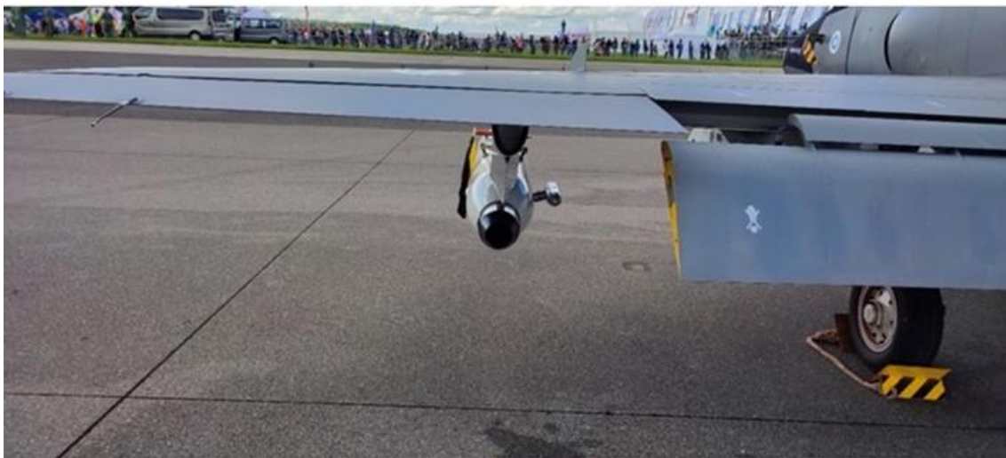
Rysunek 2.37 Wytwornica dymu pod skrzydłem samolotu BEA Hawks zespołu Midnight Hawks (widok z boku i tyłu). Źródło danych: zdjęcie własne
