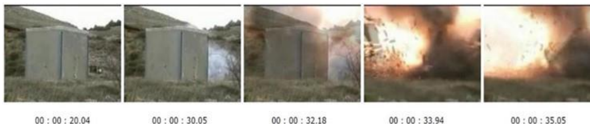
Rysunek 2.17 Pożar pirotechniki klas F3 w pomieszczeniu zamkniętym zakończony detonacją (po ok. 14 sekundach od zapłonu fontanny w Box 1 przez zapłonnik elektryczny o energii 120 mJ). Źródło danych: [49]
