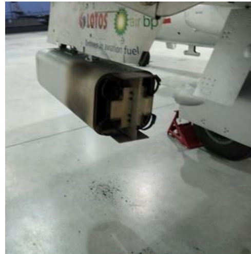
Rysunek 6.42 Stan HWP po teście „błędne zamontowanie 1 kg pirotechniki w uchwycie zasobnika” widoczne tylko ślady przegrzania tylnej części obudowy zasobnika, bez negatywnych skutków na uniwersalną belkę podwieszń i skrzydło samolotu TS-11 Iskra; cała energia spalania została zatrzymana wewnątrz zasobnika. Źródło danych: zdjęcia własne
