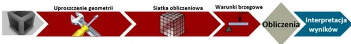
Rysunek 4.57 Schemat tworzenia procesu symulacji MES. Źródło danych: [187]
