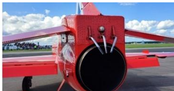
Rysunek 2.36 Wytwornica dymu pod kadłubem samolotu Hawk zespołu Royal Air Force i dysze doprowadzenia cieczi do dyszy wylotowej silnika. Źródło danych: zdjęcia własne
