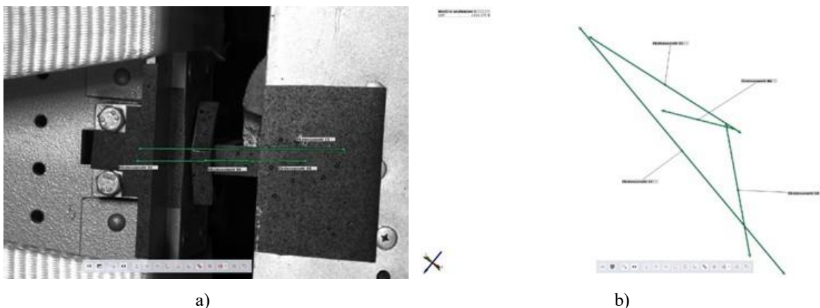
Rysunek 6.45 Zobrazowano konfigurację ekstensometrów podczas pomiaru nr 1 HZP: a) rozmieszczenie ekstensometrów na badanych elementach; b) konfiguracja przestrzenna ekstensometrów. Źródło danych: opracowanie własne
