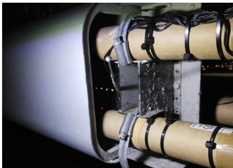
Rysunek 6.30 Położenie odbiornika DB04r w HZP – czerwona dioda sygnalizuje włączone zasilanie odbiornika; 4 zielone diody sygnalizują poprawne podłączenie ładunków pirotechnicznych. Źródło danych: zdjęcia własne
