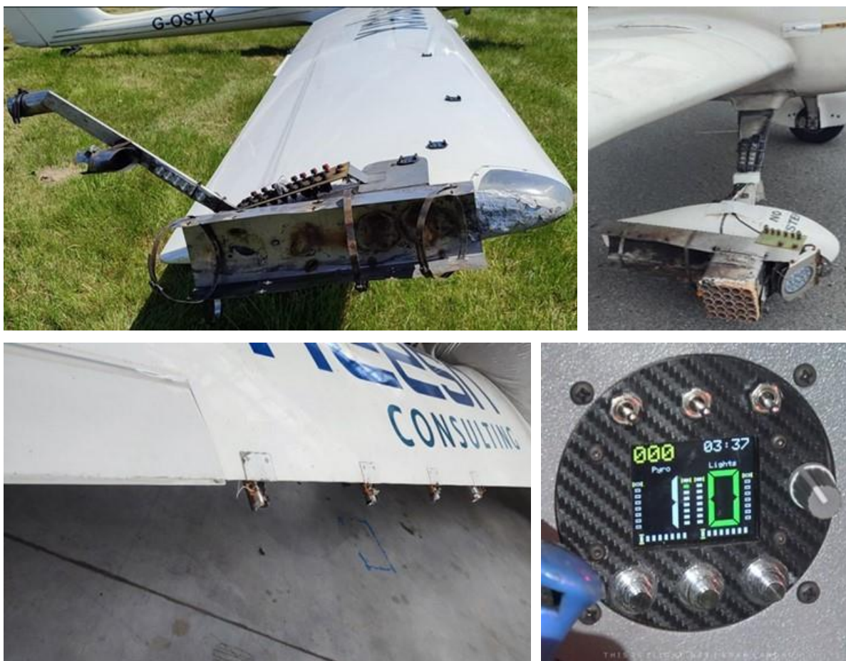
Rysunek 2.44 Mocowanie różnych typów pirotechniki na motoszybowcach GROB G109B zespołu Aerosparx oraz widok pulpitu sterowania odpalaniem pirotechniki z kabiny. Źródło danych: zdjęcie własne
