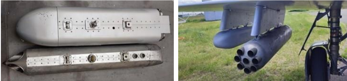
Rysunek 6.27 Porównanie cech geometrycznych: a) opracowanego HZP i zasobnika MARS-3 niekierowanych pocisków rakietowych S5; b) HZP i zasobnika MARS-4. Źródło danych: zdjęcia własne
