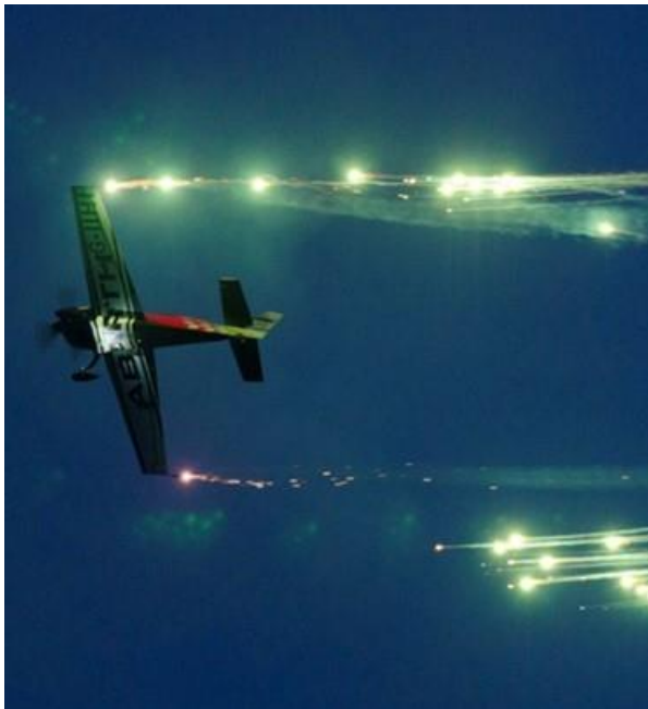
Rysunek 2.46 EXTRA 300SC znak AB-ATH: Pierwszy cywilny samolot z uzupełniającym certyfikatem typu EASA na używanie pirotechniki mocowanej na końcach skrzydeł. Czas dopalania produktów spalania podczas lotu na wznoszenie wynosi ok. 18 sekund, co pozwala łatwo zobrazować liczbę beczek kręconych na wznoszeniu. Źródło danych: [289]
