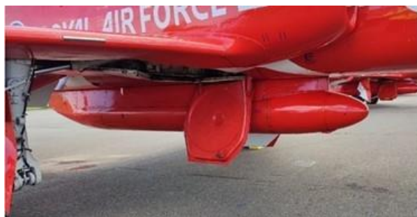
Rysunek 2.36 Wytwornica dymu pod kadłubem samolotu Hawk zespołu Royal Air Force i dysze doprowadzenia cieczi do dyszy wylotowej silnika. Źródło danych: zdjęcia własne
